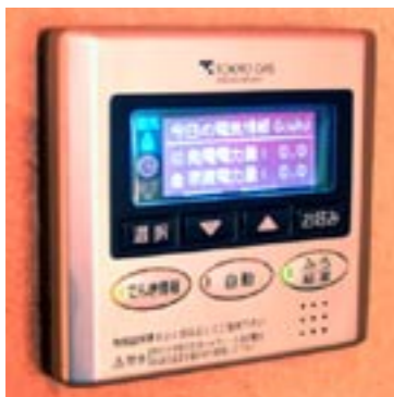
「ライフエル」の制御パネル。現在の消費電力と発電量がリアルタイムで表示されます。つつい見えてしまうため、さらに省エネ効果があがるということです。
