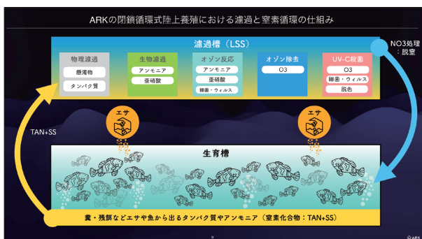
▲ARKの閉鎖循環式陸上養殖における濾過と窒素循環のしくみ
